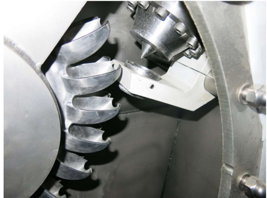
01.05.2014 Pelton turbine mit Einspritzdüse
